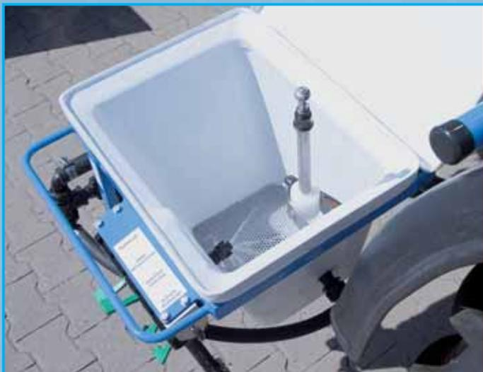
Каждый полевой опрыскиватель должен просто, быстро и безопасно наполняться средствами для защиты растений. Для этого Примус и Альбатрос предлагают промывочный шлюз большого объема. При помощи пружинного устройства он удобно приводится в транспортное или рабочее положение.
