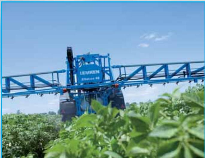
Для параллельного копирования местности, каждая штанга опрыскивателя оснащена компенсатором наклона, управление которым осуществляется с блока управления в кабине трактора. Электромотор сдвигает штанги и тем самым смещает центр их тяжести по направлению от склона. Такой компенсатор наклона поставляется серийно с ручным переключателем или опционально с электронным потенциометром.
