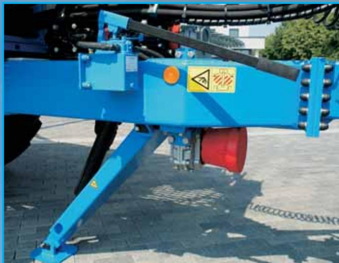
Следующим кульминационным моментом универсального тягового дышла является гидравлическая опорная стойка, которая, наряду с простым и быстрым обслуживанием, подкупает, прежде всего, своим выгодным транспортным положением. Она полностью прячется в дышло и тем самым значительно способствует образованию гладкого дна опрыскивателя.
