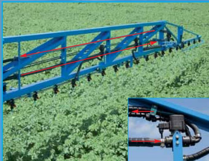
Профессиональная защита растений должна обеспечивать нужное давление раствора по всей ширине опрыскивания с первого метра обработки. Поэтому Альбатрос от ЛЕМКЕН серийно оснащается циркуляционной системой давления жидкости до самых моторов, открывающих подачу жидкости в отдельные секции штанг.
