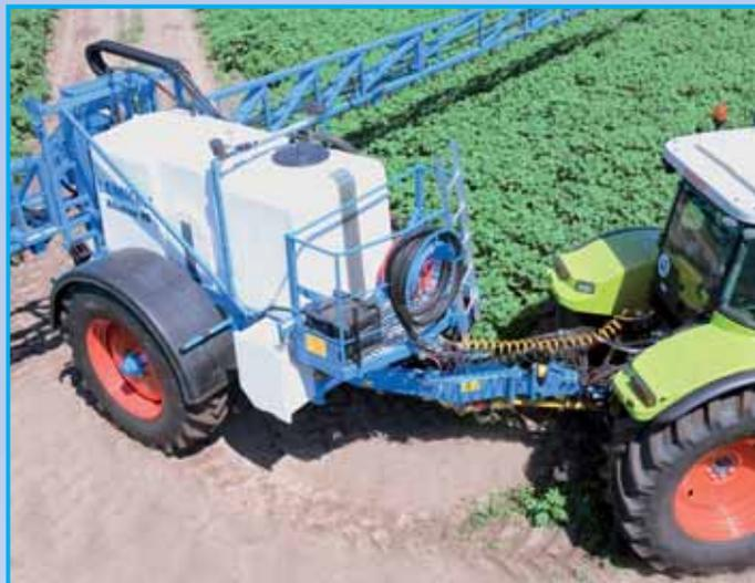
Инновационный бак с интегрированной емкостью для чистой воды, продуманные закачивающие шлюзы, также как и серийно поставляемая циркуляционная система давления жидкости - являются отличительными чертами профессионального основного оснащения полевого опрыскивателя Альбатрос от ЛЕМКЕН.
