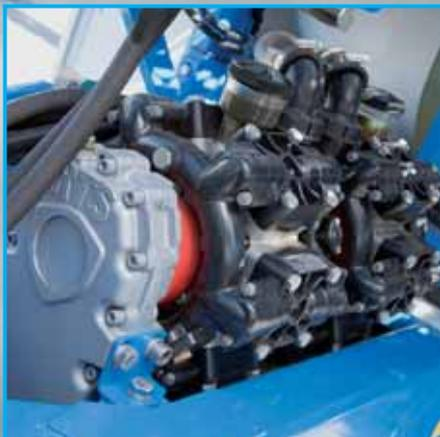
Мембранно-поршневые насосы благодаря использованию нержавеющей стали коррозионно-устойчивы к жидким удобрениям.
