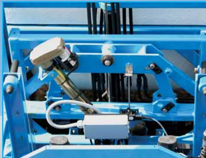
Центральное навешивание штанг в принудительном положении обеспечивает точное внесение средств защиты растений даже при высокой скорости работы.
