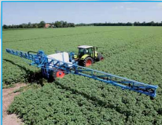
Для последующего повышения производительности ЛЕМКЕН предлагает неповторимый концепт удлинения штанг. Эта опция доступна благодаря стабильной конструкции рамы и разной ширине штанг.
