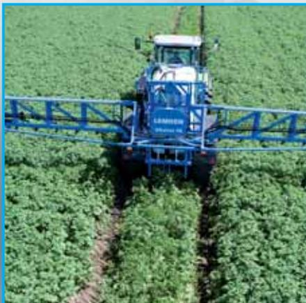
Полевые опрыскиватели Примус и Альбатрос 20,30 и 40 серийно оснащены стабильной жесткой осью с колеей 1,50 м и 1,80 м (разворот диска колеса). Широкая ось с колеей до 2,30 м для этих прицепных опрыскивателей является опциональной, а для Альбатрос 50 и 60 поставляется серийно.
