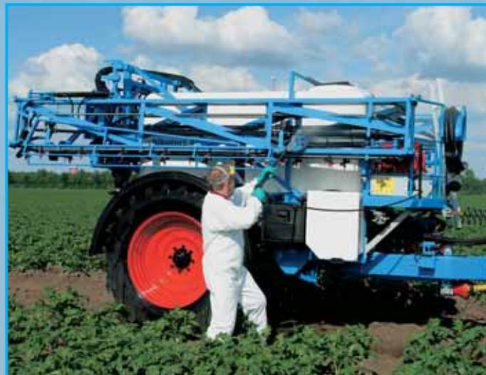
Работа в поле опрыскивателями обусловлена не только сжатыми сроками, но и дополнительно зависит от любых изменений погодных условий. При вынужденной остановке работы опрыскивателя на некоторое время все шланги и форсунки можно быстро полностью промыть чистой водой.
