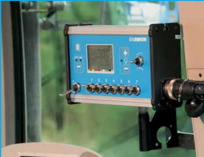
В серийную комплектацию полевого опрыскивателя Примус от ЛЕМКЕН входит компьютер Teejet 844-E. Он оптимально настроен на управляющую и регулирующую систему Примус и позволяет оператору просто управлять всеми важными функциями.
