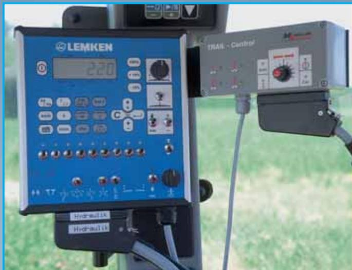
Компьютер Spraydos фирмы Мюллер позволяет из кабины трактора управлять центральным клапаном, клапанами отдельных секций и клапаном регулировки давления. В сочетании с циркуляционной системой давления жидкости он относится к серийному оснащению Альбатрос от ЛЕМКЕН.
