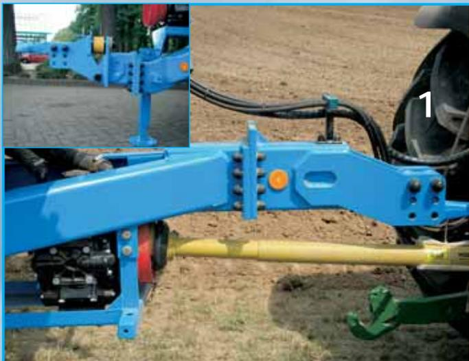
Жесткое дышло Примуса благодаря своей фланцевой пластине дает возможность использовать большое количество различных видов сцепки. Возможно не только нижнее или верхнее сцепление. Также поставляются подпружиненные секции дышла, которые значительно увеличивают комфорт при движении.
