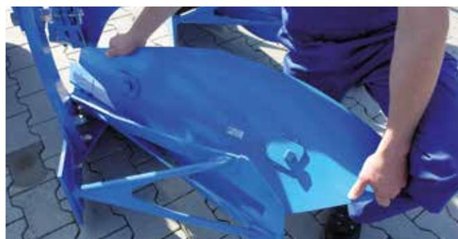
Сплошной отвал и Башмак корпуса
