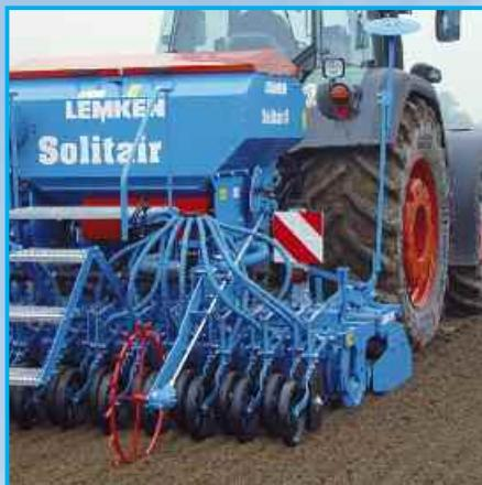
Пневматическая сеялка Солитэр 8 оснащена механическим приводом. Дозировочная система приводится при помощи, не требующего обслуживания, карданного вала и бесступенчатого редуктора. Это служит для плавного привода высевных катушек в дозировочном узле. Хвостовое колесо работает в пределах ширины орудия и всегда обеспечивает равномерный привод двух дозировочных узлов.
