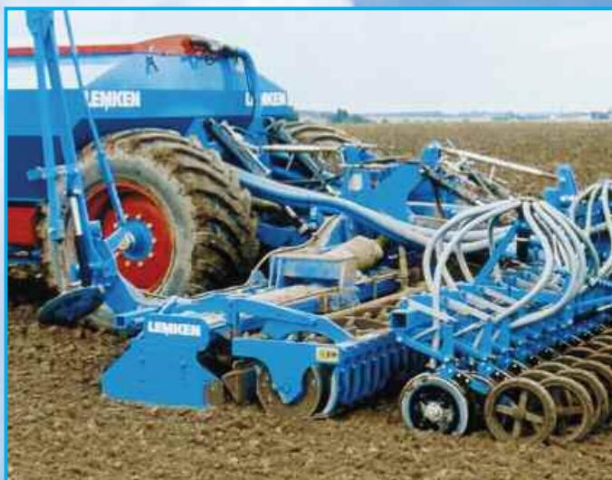
Прицепной семенной бункер базируется на шасси Солитэр 12 и оснащается дополнительным сквозным приводом карданного вала. Таким образом, Солитэр 10 может комбинироваться и применяться с ротационной бороной Циркон шириной захвата от 4 до 6 метров при помощи установленной сзади на сеялку трехточечной навески.
