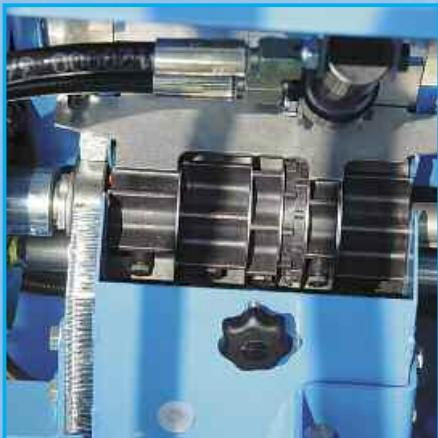
Для посева различного посевного материала норма высева регулируется шестисоставными высевными катушками в диапазоне от 1,5 до 300 кг/га при помощи поставляемого с сеялкой специального инструмента. Солитэр оснащена дозировочными узлами в количестве от двух до восьми, в зависимости от ширины захвата.
