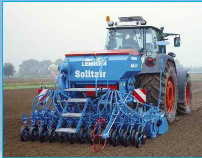
Солитэр 8 шириной захвата три и четыре метра является экономным решением при приобретении навесной не складываемой пневматической посевной техники. Солитэр 8 от ЛЕМКЕН дает возможность хозяйствам среднего размера применять недорогую точную пневматическую посевную технику с механическим приводом высевного вала и гидравлическим приводом пневмтурбины.
