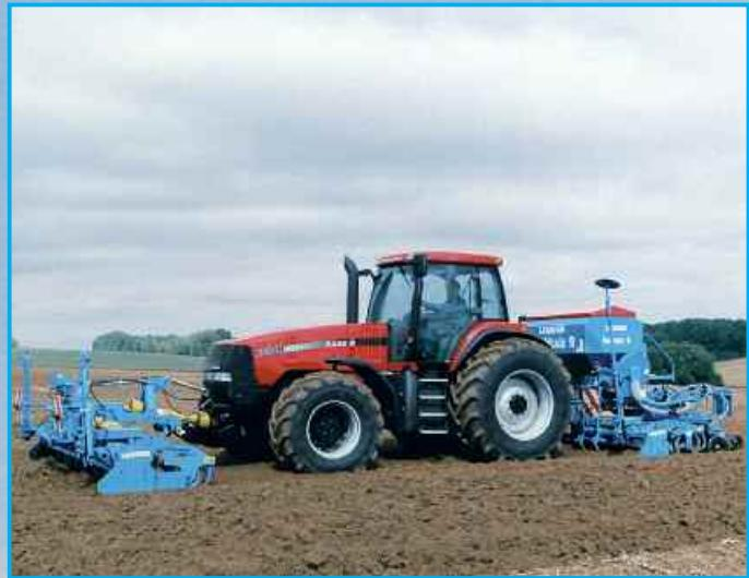
Пневматическая сеялка Солитэр 9 предлагается в виде навесной не складываемой или складываемой, а также в виде полунавесной складываемой версии шириной захвата от 3 до 6 метров. Возможность комбинирования с различными почвообрабатывающими орудиями открывает многообразные границы применения в различных технологиях посева.
