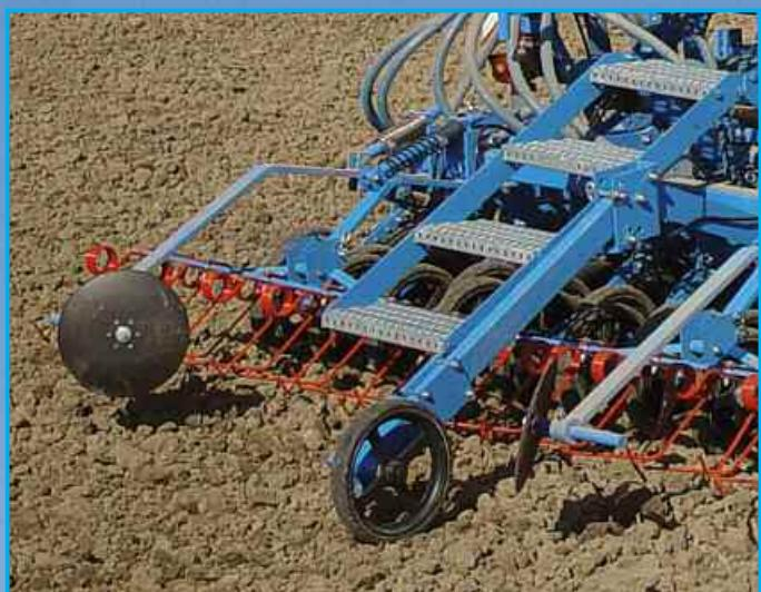
Импульсное колесо служит исключительно для измерения пройденного пути. Гарантируено движение без пробуксовок, так как движение колеса никак не связано с приводом высевного вала. Датчик на импульсном колесе служит для точного измерения пройденного пути. Импульсное колесо движется между двумя посевными рядами в пределах ширины сеялки и всегда по обработанной поверхности. За счет этого условия привода всегда одинаковы.
