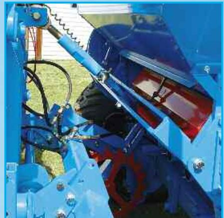
Замена сошникового бруса на агрегат точного высева возможна при помощи стандартной башни трехточечной навески для обоих навесных компонентов. Таким образом, возможна быстрая смена между технологиями посева.
