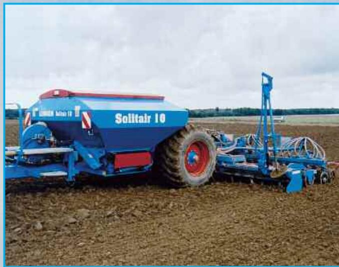
Солитэр 10 от ЛЕМКЕН является прицепной посевной комбинацией для достижения высочайшей производительности и экономичности. Прицепной бункер для семян со стабильным шасси оснащен дополнительным сквозным приводом карданного вала. Таким образом, Солитэр 10 может оснащаться ротационной бороной Циркон при помощи установленной сзади на сеялку трехточечной навески. Объем семенного бункера 5.800 литров и ширина захвата от 4 до 6 метров являются основой для высочайшей производительности.
