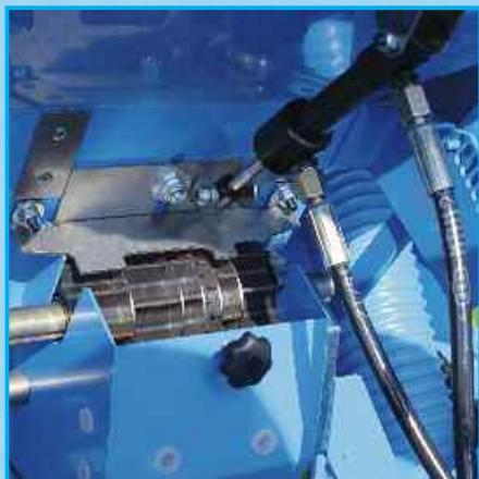
Каждый дозировочный узел можно отдельно включить или отключить. Данная функция может обслуживаться опционально при помощи электрического управления Солитэр из кабины трактора. Благодаря этому осуществляется быстрая адаптация к ритму технологической колеи или при засеве остаточных участков без больших перекрытий.
