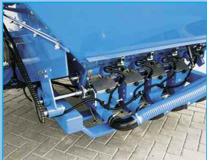
Семенной бункер объемом почти 5.800 литров просто и быстро заполняется при помощи телескопического погрузчика, Big Pack или загрузочного шнека.
