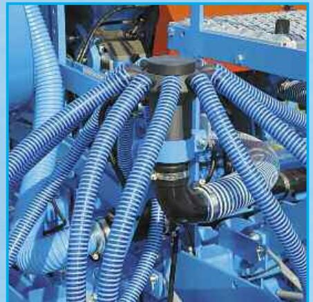
Распределители семян расположены снаружи семенного бункера, непосредственно над сошниковым бруском. Для точного распределения семян семенные трубы, соединяющие распределитель и сошник, максимально короткие и имеют одинаковую длину. Неизменное расположение с уклоном предотвращает забивания. Для осуществления контроля распределитель легко открывается.
