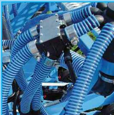
Для индивидуального закладывания технологической колеи у Солитэр могут отключаться 2x4 высевых труб, оснащенных включателями технологической колеи. При закладывании технологической колеи семена из этих труб возвращаются через большие шланги обратно в семенной бункер. Благодаря автоматическому повороту заслонки технологической колеи давление воздуха в системе остается постоянным. Равномерное распределение семян гарантируется даже при включенном ритме технологической колеи.
