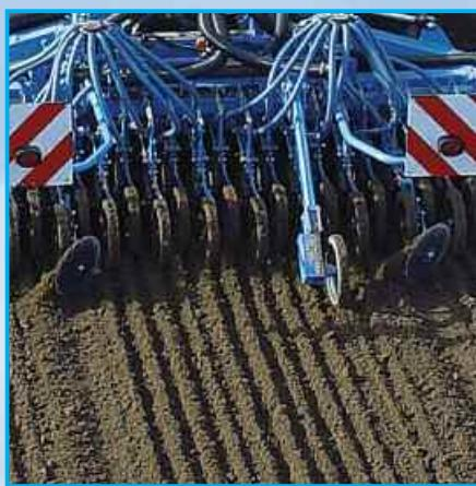
Все сеялки Солитэр ЛЕМКЕН могут по желанию оснащаться довсходовым маркером. Синхронно технологической колеи оба маркировочных диска управляются при помощи бортового компьютера. Они приводятся в действие при помощи гидравлики и стабильно двигаются в почве. Таким образом, даже на тяжелых почвах или при посеве в мульчированный слой остается хорошо различимый след. Особенным преимуществом при развороте является короткое исполнение довсходового маркера.
