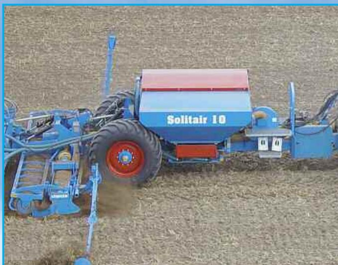
Большой семенной бункер Солитэр 10 объемом около 5.800 литров обеспечивает более длительную работу и снижает количество загрузок бункера. В Солитэр 10 могут объединяться преимущества полунавесной посевной комбинации с высокой производительностью прицепной пневматической сеялки Солитэр 12. Четыре дозировочных узла обеспечивают равномерный поток семян и хорошее поперечное распределение.
