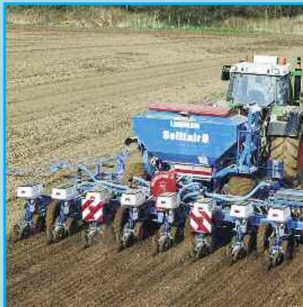
Для посева кукурузы полунаавесная комбинация из ротационной бороны Циркон и пневматической сеялки Солитэр 9 может поставляться в специальном исполнении, где на месте высевного бруса установлен восьмирядный агрегат для посева кукурузы, для того чтобы осуществлять предпосевную обработку, заделку семян кукурузы и внесение удобрений в один рабочий проход. Семенной бункер Солитэр служит в данной комбинации бункером для удобрений.
