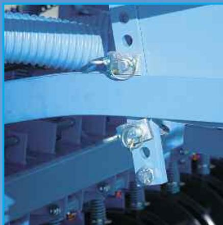
Давление на сошники централизовано передается через стабильный сошниковый брус. В навесных машинах давление регулируется механически при помощи перестановки пальца или гидравлически, опция (серийно у полуавесных машин). На каждый сошник достигается максимальное давление равное примерно 50 кг.
