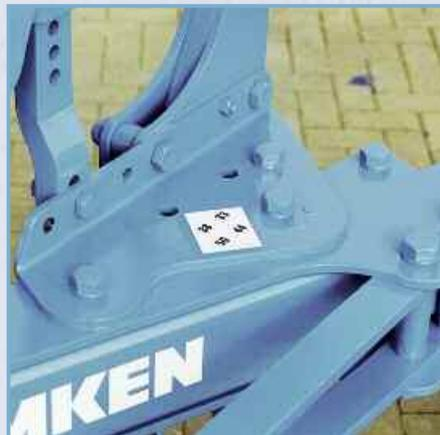
Кронштейны изменения ширины захвата ЕврОпала не привариваются, а привинчиваются к раме. Благодаря этому достигается большая стабильность, повышенная прочность и точность сборки. Четыре различные ширины захвата между 30 см и 50 см устанавливаются быстро и просто ослаблением центрального винта и переустановкой регулировочного винта.
