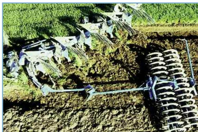
Положение рычага захвата почвоуплотнителя плугов ЕврОпал и Вари-Опал регулируется легко и точно с помощью перестановки болта.
