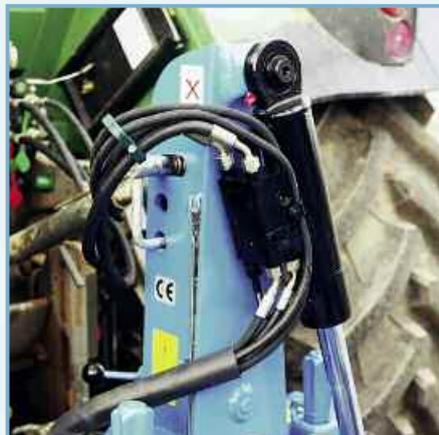
Клапан переключения находится в защищенном месте рядом с гидроцилиндром. В связи с этим возможна быстрая замена и расширение регулирующих устройств. При наличии отдельного возвратного трубопровода в масляный бак трактора все оборотные плуги фирмы ЛЕМКЕН могут быть присоединены к трактору с всего лишь одним регулирующим устройством простого действия.
