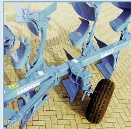
Большое расстояние между корпусами, сбоку от рамы установленные плужные корпуса и специфическая форма стоек корпусов обеспечивают довольно большое свободное пространство между корпусами. Тем самым гарантируется работа без забивания рабочих органов даже при небольшой ширине захвата. Все серийные корпусные стойки оснащены предохранительными срезными болтами. Скручивание корпусных стоек исключается благодаря их надежному креплению с двух сторон.
