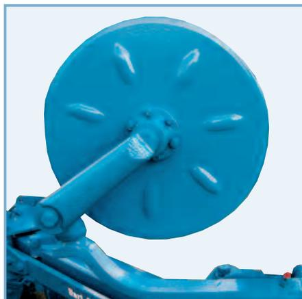
Гладкий дисковый нож диаметром 500 мм имеет боковые канавки по линии радиуса. Таким образом обеспечивается его постоянный привод даже при наличии большого количества органической массы на поле. Установление рабочей глубины работы производится вертикальным поворотом стойки дискового ножа, которая крепится винтом и фиксируется зубчатым профилем. Подшипник диска имеет двойную герметизацию против загрязнений. Подшипниковый узел – гладкий и не выступает в сторону свеж вспаханной земли.
