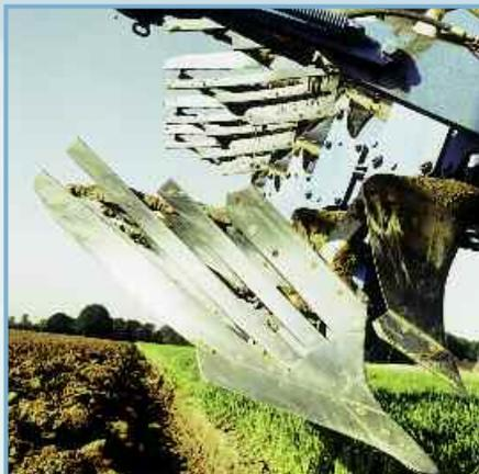
Полосы полосового корпуса плуга изготовлены из толстой, полностью закаленной специальной высококачественной стали. Они легко заменяются независимо друг от друга. Соединительные винты крепятся глубоко, за счет чего обеспечивается прочная посадка полос и длительный срок службы. Полосы можно без проблем заменять нормальными отвалами благодаря одинаковым башмакам корпусов.
