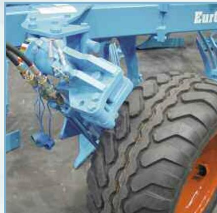
Оптимальная работа плуга предполагает возможность изменения рабочей глубины в зависимости от почвенных условий и при переходе от легких к тяжелым почвам в процессе работы. При пахоте последней борозды на меньшую глубину водителю не нужно больше выходить из трактора.
