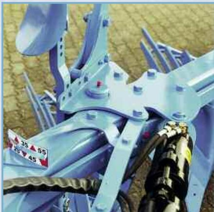
Пластины рамы, по которым закреплены узлы поворота, не привариваются, а привинчиваются болтами к раме. Благодаря этому повышается точность сборки рамы, ее прочность и устойчивость к динамическим нагрузкам.
