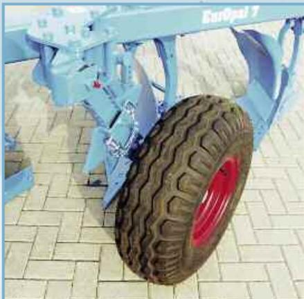
Специальная конструкция гарантирует большое свободное пространство между землей и плугом. После разворота плуга четко фиксируется рабочее положение опорного колеса.
