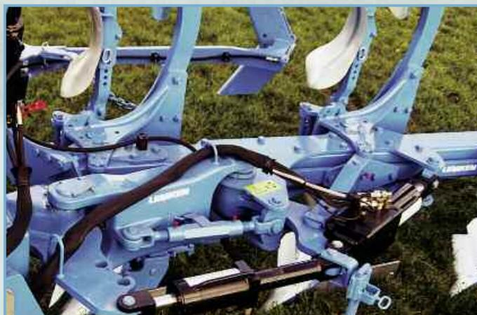
Необходимые датчики и гидравлические блоки управления находятся в цилиндрах разворота и изменения ширины захвата плуга и являются их неотъемлемой частью.
