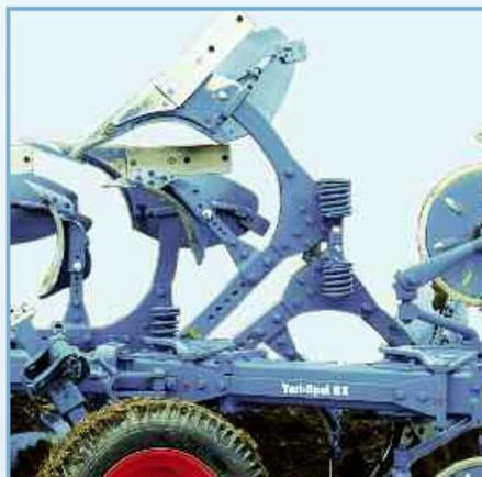
На роликах, движущихся между сдвоенными грядиллями, ни при выходе корпуса из почвы, ни при повторном внедрении в неё существенных сил трения не возникают. Это означает, что потери усилия при повторном введении корпуса плуга в почву снижены до минимума.
