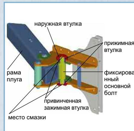
Основные болты шарнирных соединений оснащены зажимными втулками и надежно закреплены между пластинами рамы, что делает невозможным их скручивание. Узел поворота также оснащен прижимными втулками. Таким образом обе находящиеся одна в другой смазывающиеся втулки гарантируют долгий срок работы опор даже при самых тяжелых условиях. В случае износа каждая деталь отдельно заменяется.
