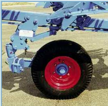
Начиная с 4-х пар корпусов плуг рекомендуется оснащать комбинированным опорным и транспортным колесом типа УНИРАД. Колесо типа УНИРАД легко переводится из рабочего положения в транспортное и обратно. Изменение рабочей глубины осуществляется быстро без поднятия опорного колеса путем перестановки забивного штифта.
