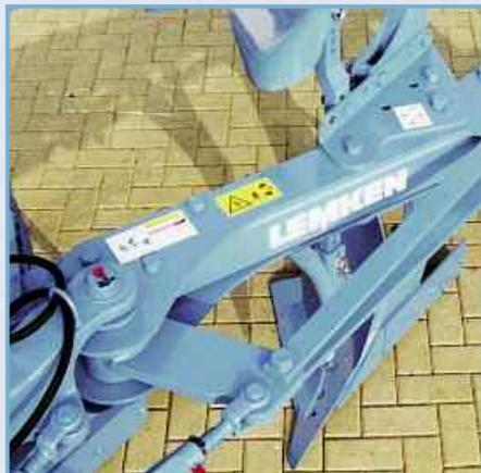
Прочная и толстостенная рама, выполненная из профиля прямоугольного сечения, изготовленная из специального мелкозернистого стального микросплава, обеспечивает высокую стабильность новой конструкции рамы. Рама имеет небольшой вес и обеспечивает длительный срок службы плуга. К задней части рамы приварен фланец, который позволяет присоединить одну дополнительную пару корпусов.
