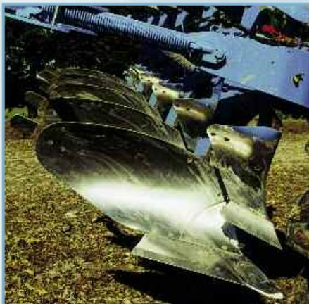
Башмак корпуса упрочняется за счет термообработки и поэтому очень устойчив. Угол атаки корпусов плуга регулируется при необходимости индивидуально. Благодаря этому обеспечивается всегда хорошее вхождение плуга в почву. Благодаря мягкому переходу от лемеха к отвалу тяговое сопротивление снижается до минимума.
