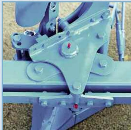
Узел поворота шарнирных соединений расположен вблизи корпуса вне рамы, что позволяет максимально разгрузить подшипниковые узлы и комплектующие. Все шарнирные соединения оснащены износостойкими втулками и закаленными болтами, которые удобно смазываются. Это гарантирует высокую стабильность и долгий срок службы.
