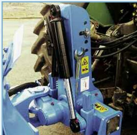
Все плуги фирмы ЛЕМКЕН оснащены современным гидравлическим механизмом поворота УНИТУРН и переключающимся цилиндром двойного действия с автоматическим переключающимся клапаном, а также автоматической фиксацией вертикального положения плуга в борозде.
