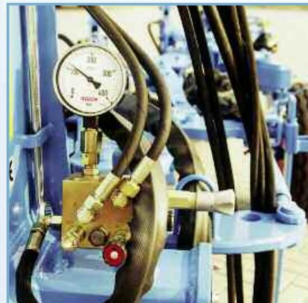
Возможный диапазон регулировки между 50 и 140 бар устанавливается ручным колесом на блоке управления следующим образом:
