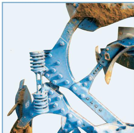
Предплужники для ЕвроПал и ВариОпал, оснащенные предохранителем от перегрузок, легко переставляются на грядилах. Так изменяется их расстояние от основных корпусов. Глубина работы предплужников устанавливается без применения инструментов при помощи забивного штифта. Для установления угла бросания органической массы в борозду предлагается круглая стойка, благодаря которой позиции предплужников фиксируется винтом.
