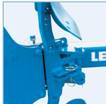
При желании плуги ЕвроПал и ВариОпал оснащаются устройством для регулировки угла бросания органической массы. При помощи такой перестановки угла бросания обеспечивается оптимальная запашка органической массы.
