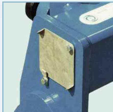
Плуги фирмы ЛЕМКЕН удобны в обслуживании. Инструменты, предохранительные срезные болты и прочие мелкие детали находятся всегда под рукой, в ящике с инструментами.
