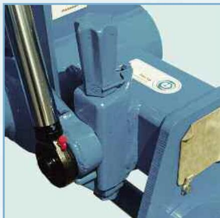
Вертикальное положение плуга в борозде регулируется колпачковыми гайками независимо друг от друга. Они легко регулируются и предохраняют резьбу от загрязнения. Благодаря этому можно всегда легко изменить уклон плуга в борозде.
