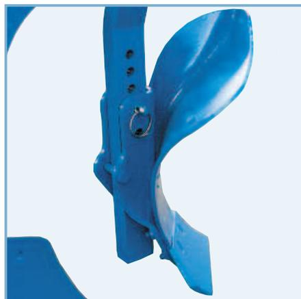
Благодаря специальной конструкции плоской стойки корпуса исключается скручивание предплужника. Все виды лемехов и отвалов можно легко заменить, так как башмак всех типов предплужников одинаков. Для вспашки без предплужника стойки можно легко снять, отвинчивая всего лишь два винта.
